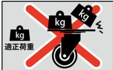
適正荷重以上の荷物を載せないこと。積荷を落下させるなどの極度の荷重を与えないこと。
