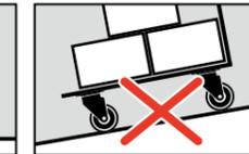
キャスターを取り付けた運搬車を傾斜面に放置しないこと。
