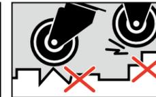
段差のある面で落下させるなどの衝撃荷重を加えないこと。凹凸の激しい面や鋭利な突起のある床では使用しないこと。
